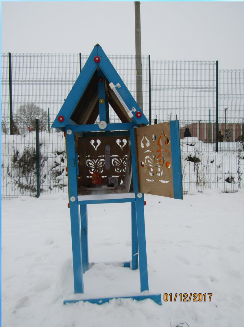
Метеобудка с термометром, гигрометром, барометром
