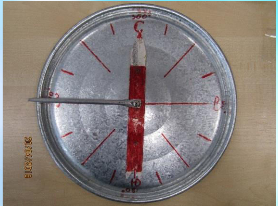
«Ветряной» компас для фиксации данных с флюгера
